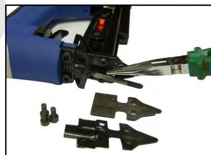
Figura 20 – Rimozione del punto incastrato.
