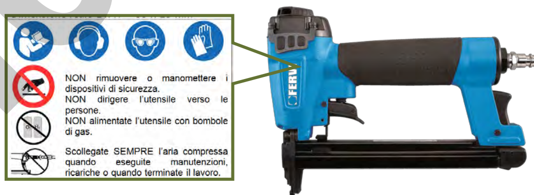
Figura 5 –Pittogrammi presenti sull'utensile
